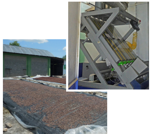
Abbildung 26: Beliebtestes Projekt der Kaka- und Kaffeekooperative in Peru Kakaoverarbeitung und Lagerinfrastruktur in Sisa, Peru. Elektronisches Auge zur Sortierung der Kaffeebohnen in einer Lagerhalle in Lamas, Peru.
